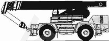
25 т Короткобазовый кран (MS 333 N) грузоподъемность: 25 т высота подъема: 33 м рабочий вес: 22,6 т
