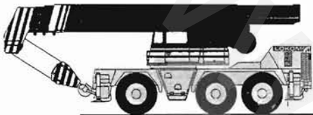
35 т Короткобазовый кран (MS 335 N) грузоподъемность: 35 т высота подъема: 52 м рабочий вес: 36 т
